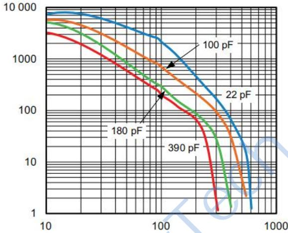
Q 值与频率的关系 (X: 频率 MHz, Y: Q 值)
